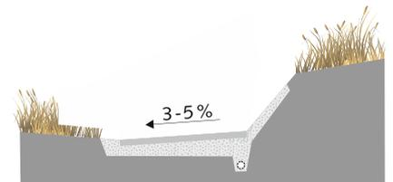
Entwässerung von vernässten Stellen oder Böschungsquellen mit Sickerpackung, Entwässerung über die Schulter oder über Längsleitung.
